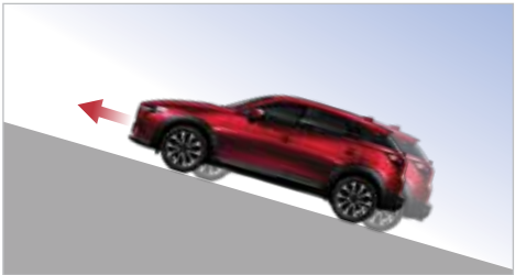
HLA (Hill Launch Assist) ระบบช่วยออกตัวรถขณะอยู่บนทางลาดชัน
