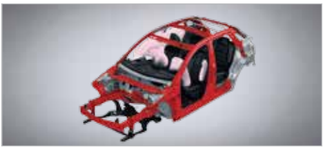
โครงสร้างตัวถังสกายแอคทีฟ พร้อมถุงลมและม้านถุงลมนิรภัย
