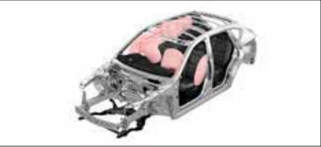
โครงสร้างตัวถังสกายแอคทีฟ พร้อมดุมลมและบานดุมลมนิรภัย
