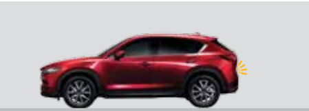
เมื่อผู้ขับขี่เหยียบเบรกละก้านคันจนรถหยุดนิ่ง สัญญาณไฟเตือนฉุกเฉินยังคงกะพริบเพื่อเตือนรถคันหลัง
