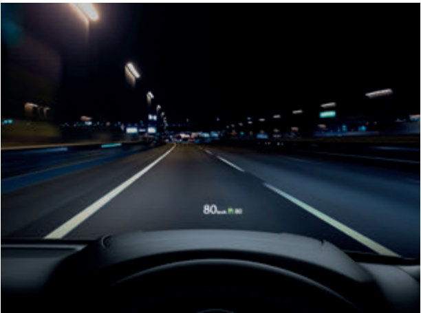
หน้าจอแสดงข้อมูลการขับขี่แบบสี บนกระจกหน้า Windshield Active Driving Display
